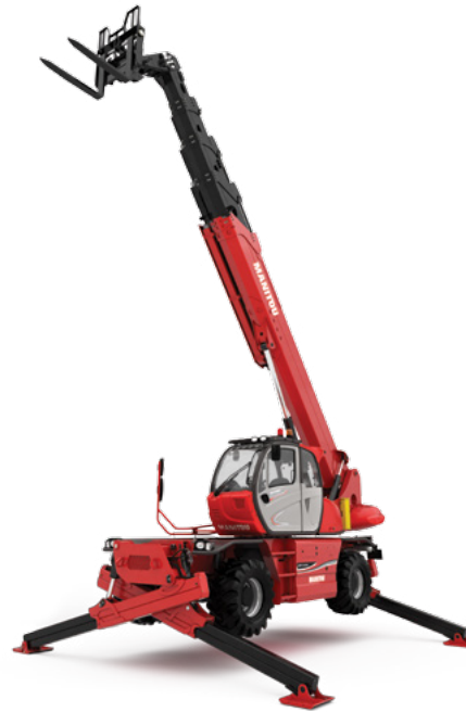
Rotation sur stabilisateurs déployés avec treuil 5000 kg
