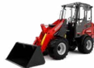
MLA Chargeuse articulée avec cinématique en Z *3
