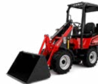
MLA Chargeuse articulée avec cinématique parallèle *2
